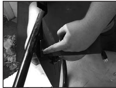
Step 8 • Paso 8 • Étape 8 Install black motor cover. Insert tab in slot on side of plate above the motor • Instale la cubierta negra del motor. Inserte la pestaña en la ranura de la placa arriba del motor • Installez le capot noir du moteur. Introduisez les languettes dans la fente sur le côté de la plaque au-dessus du moteur
