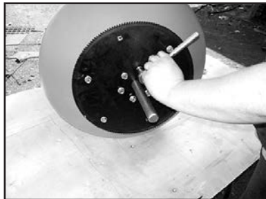
Step 13 • Paso 13 • Étape 13 Install bolts leaving out the three that do not have nuts welded to the inside • Instale los tornillos, dejando fuera los tres que no tienen tuercas soldadas en el interior • Installez les boulons en laissant les trois qui n'ont pas d'écrous soudés à l'intérieur
