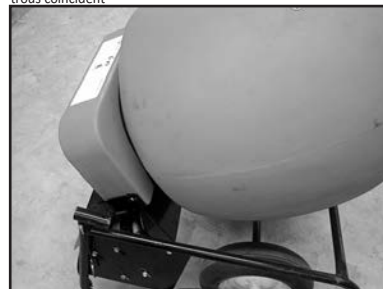
Step 16 • Paso 16 • Étape 16 Slide drum shaft through the large housing on the frame. Make sure to install the 1" thrust washer on the back of the drum. Slide locking collar into place and tighten set screw • Deslice el eje del tambor a través del gabinete grande del chasis. No olvide instalar la rondana de 1" en la parte trasera del tambor. Deslice el collarin de bloqueo en su lugar y apriete el tornillo de fijación • Faites glisser l'arbre à travers le grand carter sur le châssis. Assurez-vous de placer la rondelle de butée de 1 po à l'arrière du tambour. Faites glisser le collier de verrouillage et serrez la vis de pression
