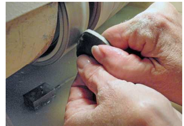
Polishing the edge of a slab.
