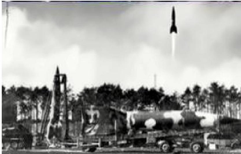
La fusée V-2 de 14 m est propulsée par de l'alcool et de l'oxygène liquide à une altitude de 90 km à une vitesse de 5 400 km/h avec une autonomie de 320 km et une charge de 740 kg. Toutes les fusées modernes, y compris la fusée lunaire Saturn V, sont basées sur le concept A4.
