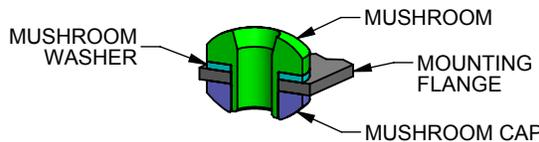
**FIG 2A: TYPICAL INSTALLATION**
