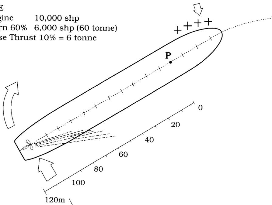
$6 \text{ tonne} \times 110 \text{ metre} = 660 \text{ tm}$
