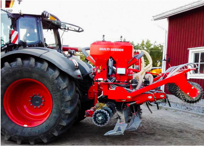
Figura 4 Grass-Tiller con sembradora y abonadora. Descompactar, airear, nitrogenar, sembrar y abonar al mismo tiempo
