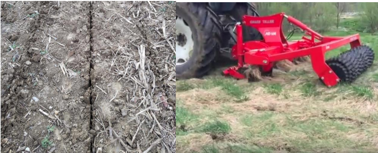
Figura 2 Trabajo del Grass-Tiller sobre la superficie del suelo
