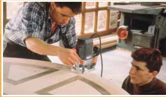
Apprentissage de la menuiserie Démonstration faite par un Compagnon Menuisier à un jeune d'un profilage mouluré sur le plateau d'une table en arasé. © G. Cichowles. Photothèque des Compagnons du Devoir
