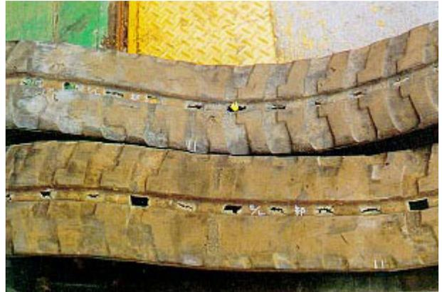
La abrasión de los salientes es poco más que inevitable. Incluso cuando los salientes estén sufriendo abrasión se pueden usar las orugas de goma. No obstante, y puesto que este deterioro lleva consigo el deterioro de las prestaciones de tracción, se recomienda fervientemente sustituir las orugas desgastadas por unas nuevas cuando la altura de los salientes sea inferior a 5 mm.
