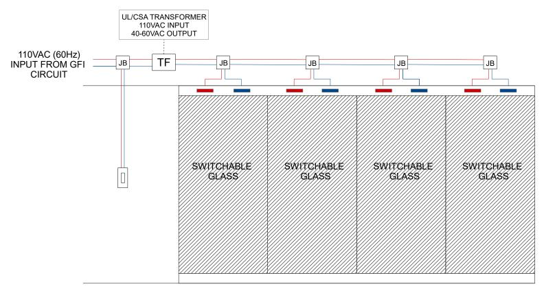
ALL PANELS CONTROLLED SIMULTANEOUSLY
