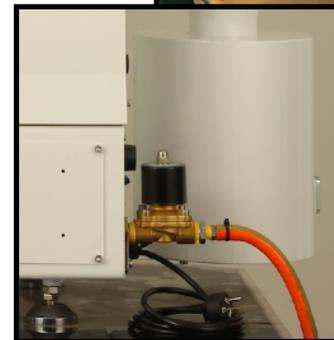
**ON BC-1-5 THE GAS CONNECTION TO SOLENOID IS ON BACK BELOW UTILITY DOOR TO DRUM MOTOR**
