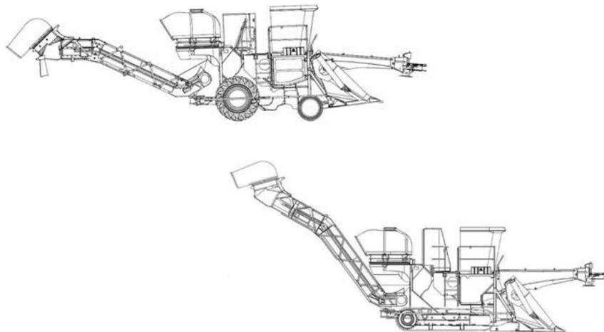
**Colhedora de forragem ou forrageira autopropelida:** equipamento agrícola automotriz apropriado para colheita e forragem de milho, sorgo, girassol e outros. Executa o corte da planta, sendo capaz de colher ou recolher, triturar e recolher a cultura cortada em contentores ou veículos separados de transbordo.
