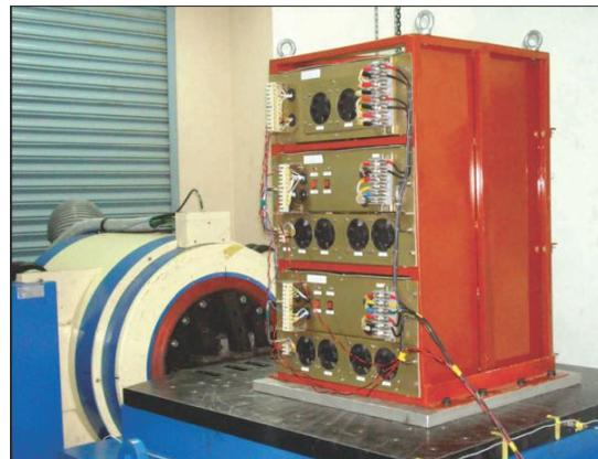
Figure-4: SEISMIC SHAKE TABLE
