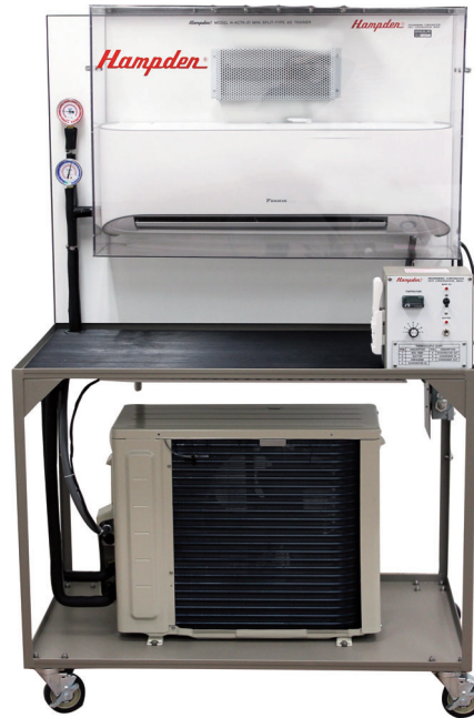
MODEL H-ACTK-21 Mini Split-Type Air Conditioner Trainer
