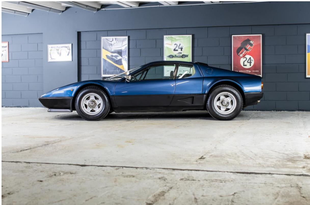
Avec une vitesse de 280 km/h et le kilomètre départ arrêté couvert en 25 secondes, les performances sont proches de celles de la Daytona. La différence est ailleurs. C'est dans l'agrément de conduite que la BB affirme sa supériorité sur la Daytona au moteur avant, lourde et fatigante à conduire. Plus légère et plus maniable, la BB s'avère aussi plus confortable grâce à ses suspensions assouplies.
